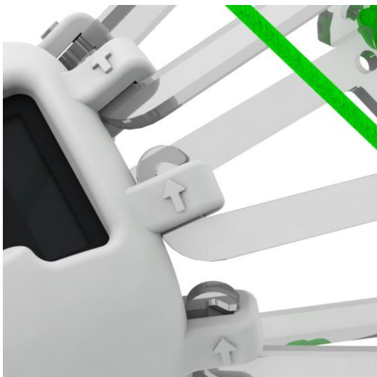
alas colocadas en las aberturas
